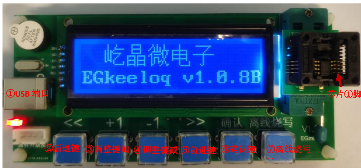
图 1-1 EGKeeloq 烧写器硬件实物图
